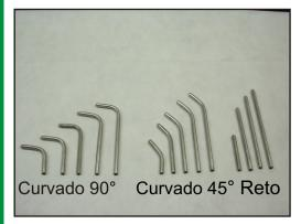
Bicos bebedouros em aço inoxidável AISI 304, polidos, diâmetro externo 8mm. com furo de passagem dimensionado de forma à evitar o gotejamento espontâneo. Diâmetro do furo de passagem: 1,9 ± 0,1mm. Comprimentos disponíveis: 80, 100, 120, 150 e 200 mm.
