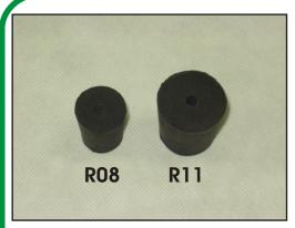
Rolhas de borracha formato tronco-cônico, com formulação anti-ácida, isentas de enxôfre, autoclaváveis, com furação 7,8 mm.
